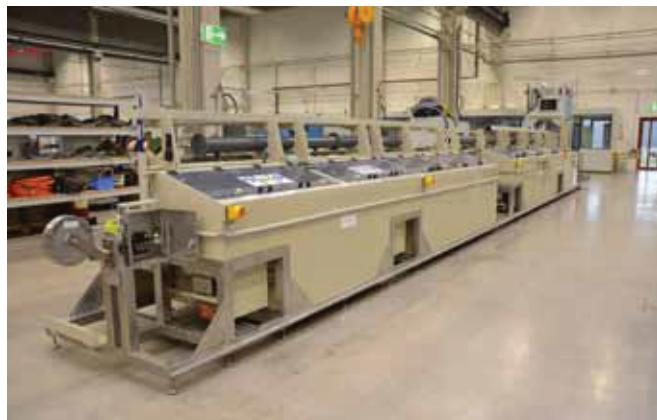
и охлаждающей жидкости приставки отжига, который предотвращает загрязнение оборудования и образование стружки на поверхности проволоки». Приставки отжига «Нихофф» серии RM оснащены специальным устройством очистки, которое снимает налет олова с контактной трубы и таким образом позволяет значительно снизить ее износ. Возможность отжига луженой проволоки при полном отключении подачи защитной атмосферы в основную зону отжига повышает общую эффективность линии.
